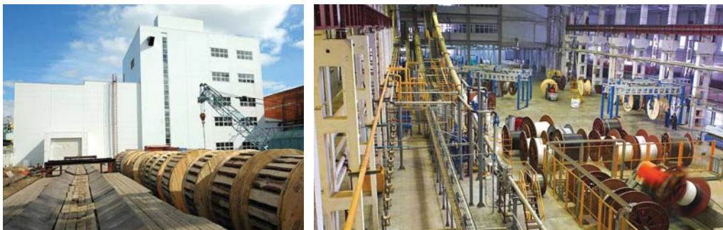
Фото: Цех по производству кабелей с изоляцией из сшитого полиэтилена. Линии изолирования ELP 30 (6–35 кВ) и ELP 50 (6–220 кВ) Mailliefer
