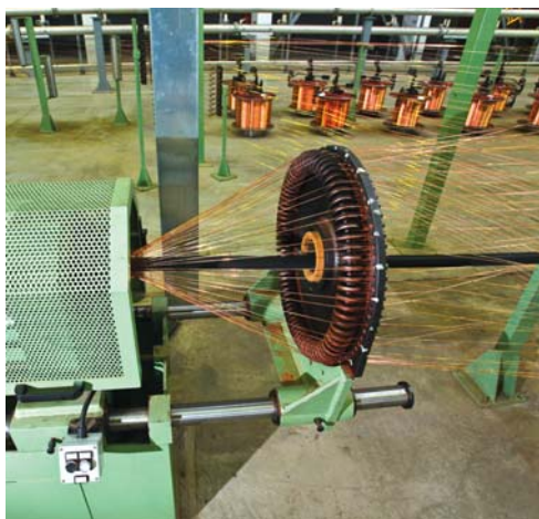
Фото: Линия общей скрутки и экранирования Drum Twister 3000 Cortinovis. Производство кабелей с изоляцией из сшитого полиэтилена 110–220 кВ
