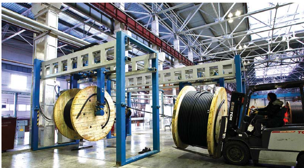
Фото: Производство кабелей с изоляцией из СПЭ
