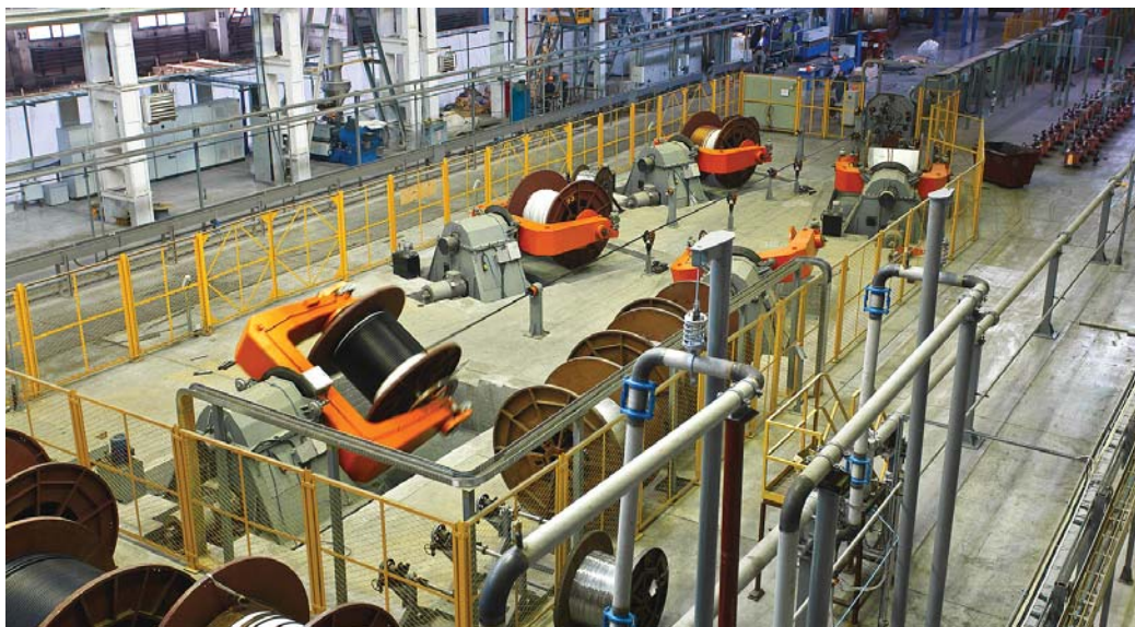
Фото: Производство кабелей с изоляцией из СПЭ
